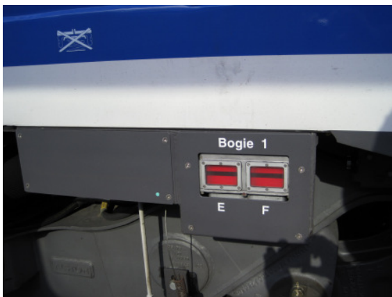
Abb. 9.2.1: Schauzeichen Druckluftbremse am Mittelwagen R1 außen
