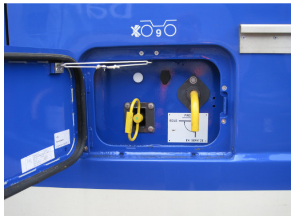
Abb. 9.2.2: Absperrhahn und Lösezug Druckluftbremse am Mittelwagen R4 außen hinter einer mit Piktogramm gekennzeichneten Seitenklappe
