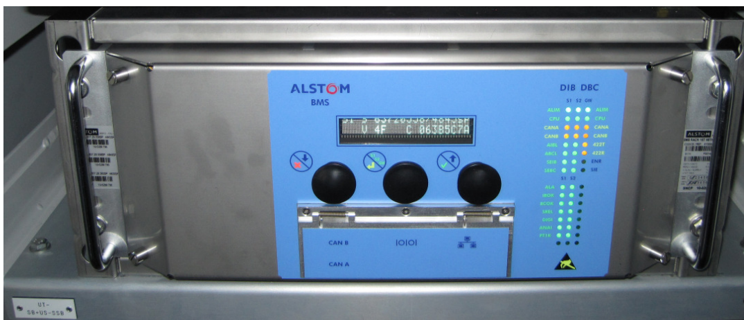
Abbildung 3.1.2 : Fahrzeugrechner „UT SSB“ für die Drehgestellüberwachung im Wagen R7
