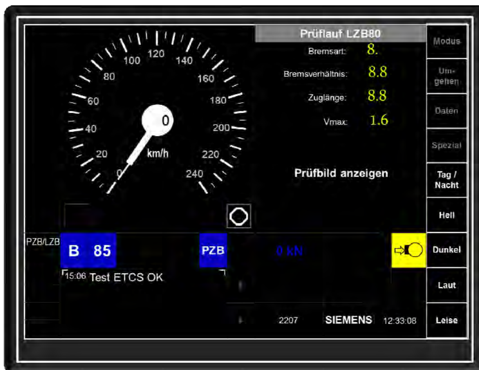
Abbildung 6-3.2 MFD-Bild bei Beginn des „Prüflauf LZB80“
