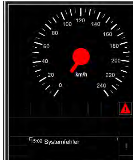
Abbildung 3-10-1.2: MFD-Bild bei gestörtem ETCS-Fahrzeuggerät im Mode „Systemfehler“
