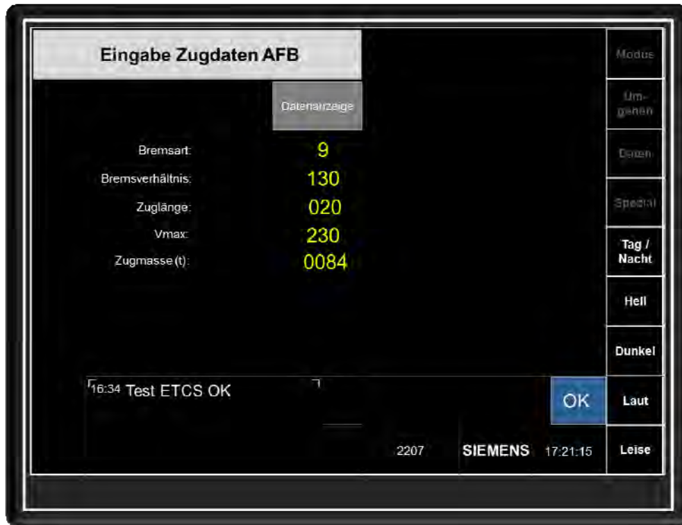
Abbildung 5-1-6.3 MFD-Bild „Eingabe Zugdaten AFB“ mit den übernommenen Zugdaten
