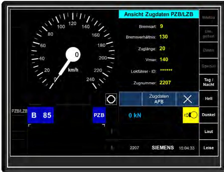
Abbildung 5-1-8.2 MFD-Bild „Ansicht Zugdaten PZB/LZB“ (nach gestartetem SOM)
