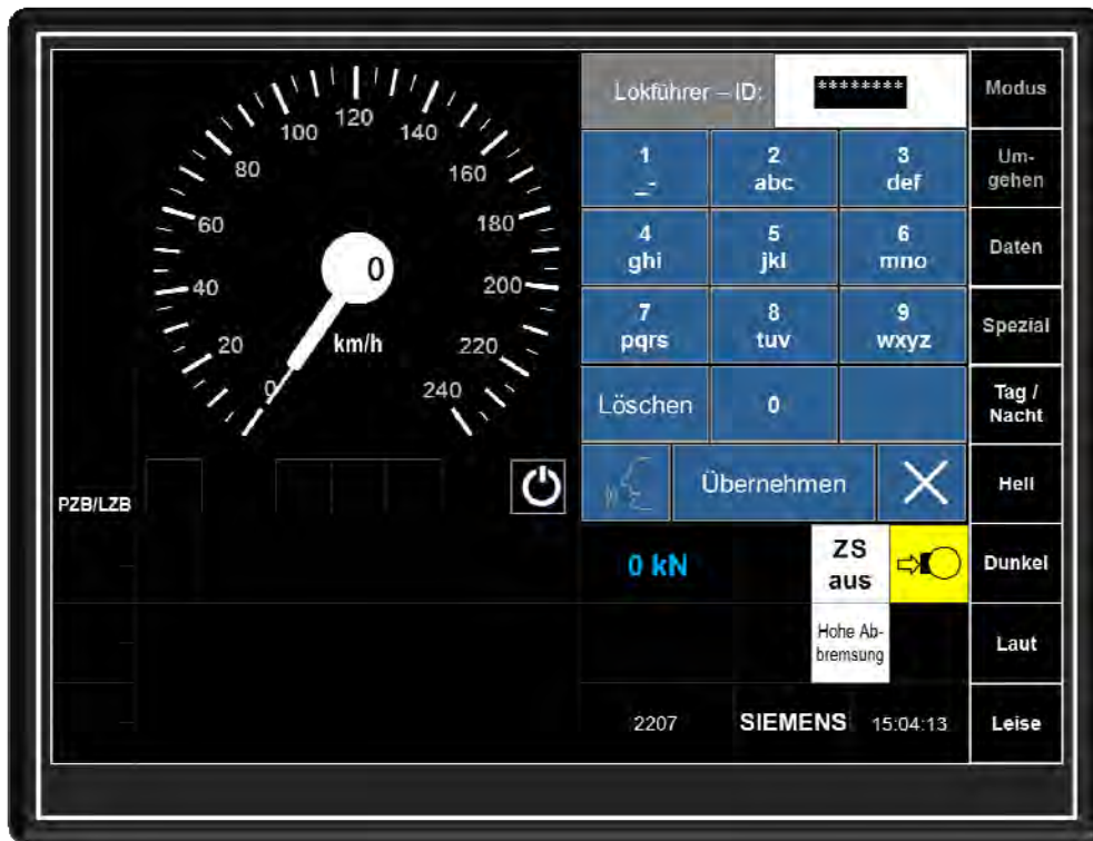
Abbildung 5-1-1.2: MFD-Bild „Lokführer-ID“ bei „ETCS ON“
