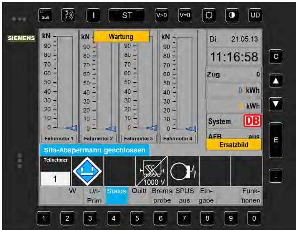
Abbildung 8-1.1: MTD-Bild nach Betätigen des Hardkey „UD“
