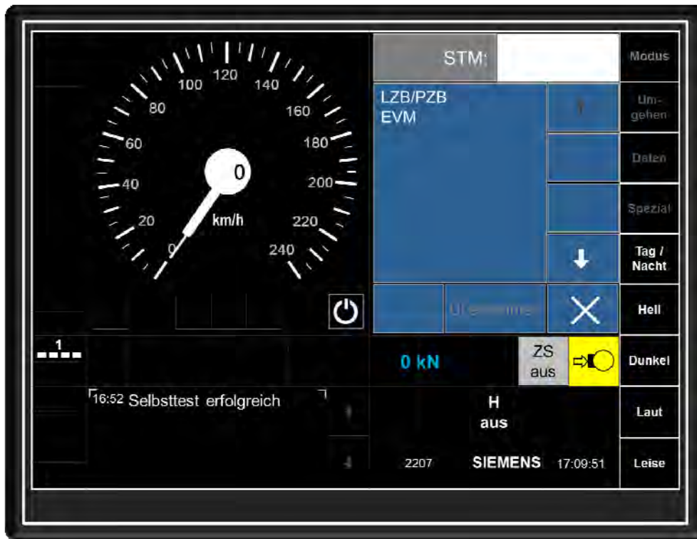
Abbildung 5-1-2.4: MFD-Bild „Eingabe ETCS Level“ zum Auswählen der verfügbaren STM „PZB/LZB“ oder „EVM“ mit den Pfeiltasten
