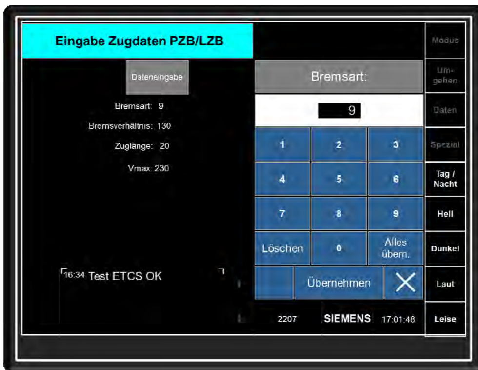
Abbildung 5-1-5.2 MFD-Bild „Zugdateneingabe“ (mit aktiver Eingabe der Bremsart)
