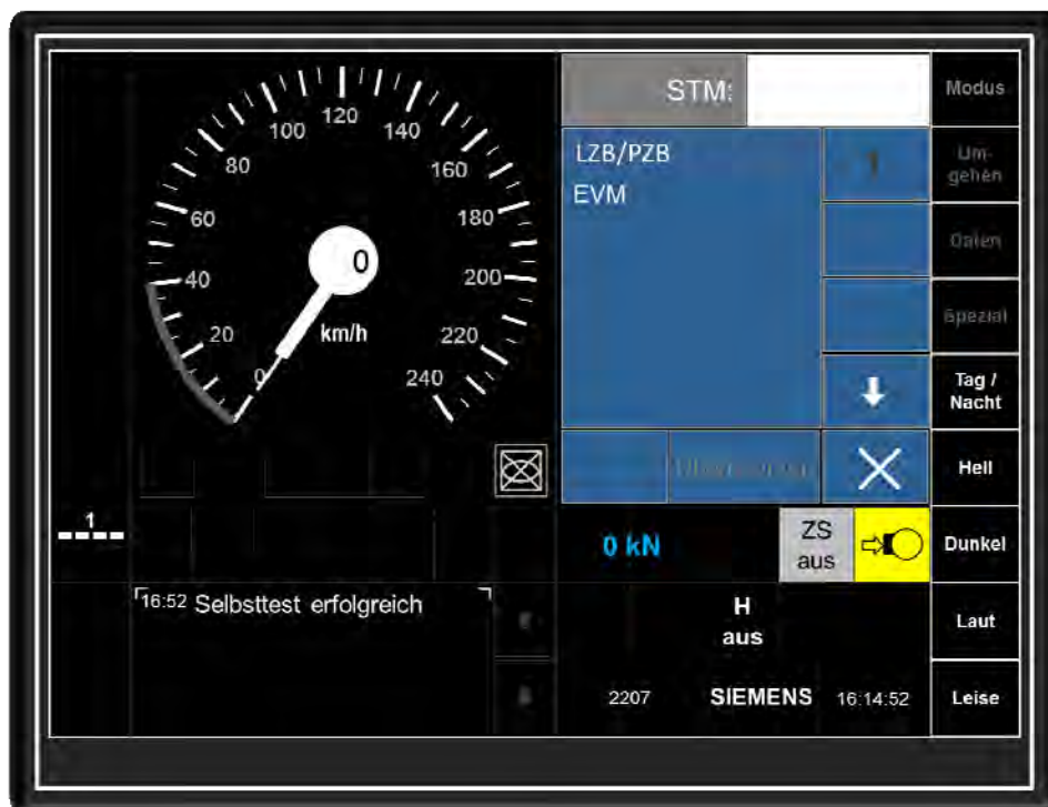
Abbildung 5-2.3 MFD-Bild „Auswahl STM“ nach Anwahl manuelle Levelwahl „STM“
