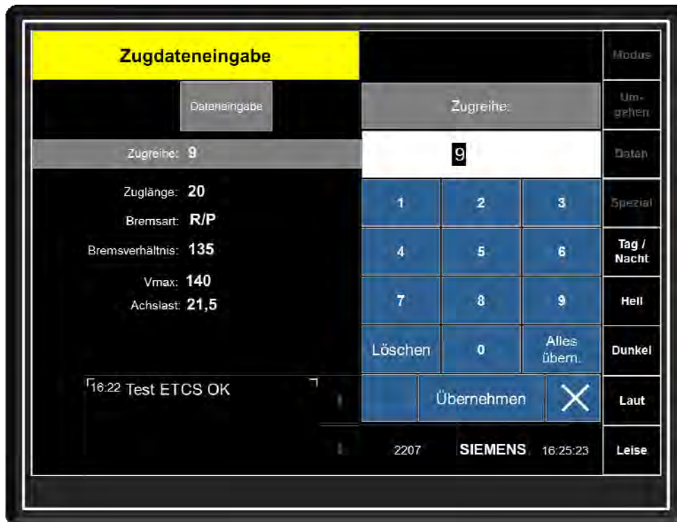
Abbildung 5-1-4.1 MFD-Bild „Zugdateneingabe ETCS“
