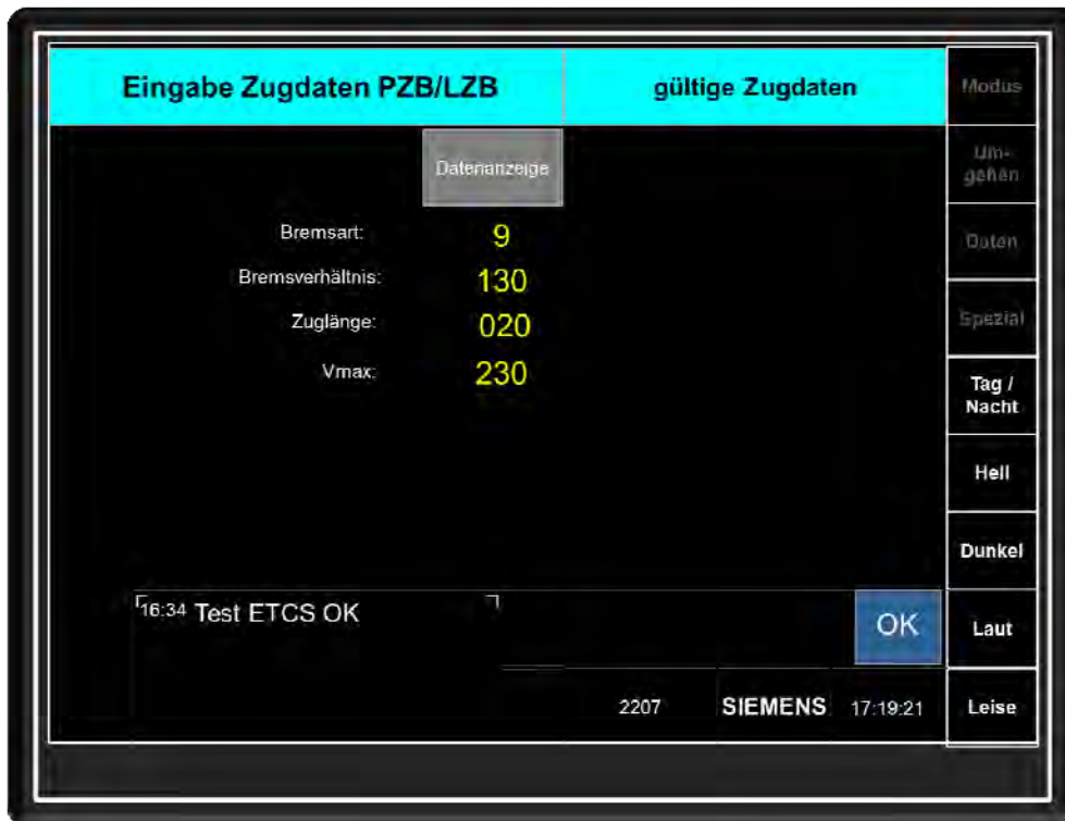
Abbildung 5-1-5.5 MFD-Bild „Zugdateneingabe“ (mit gültigen Zugdaten)
