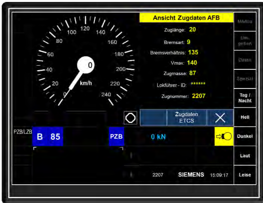
Abbildung 5-1-8.3 MFD-Bild „Ansicht Zugdaten AFB“ (nach gestartetem SOM)
