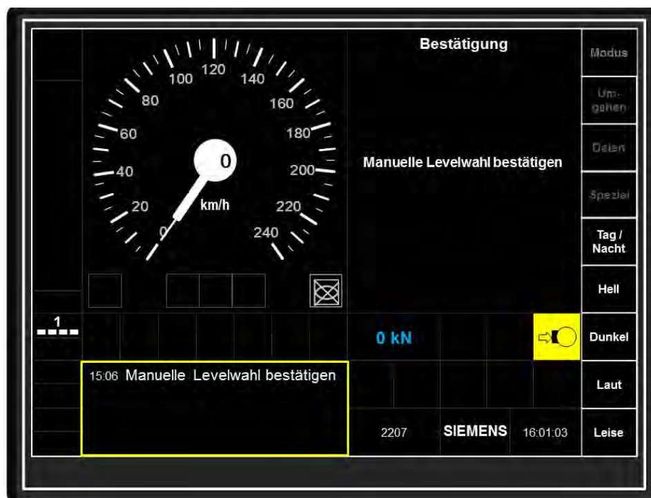
Abbildung 5-2.4 MFD-Bild „Manuelle Levelwahl bestätigen“
