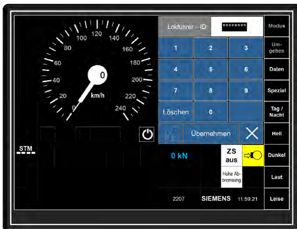
Abbildung 5-1-1.1: MFD-Bild „Lokführer-ID“ bei ETCS OFF
