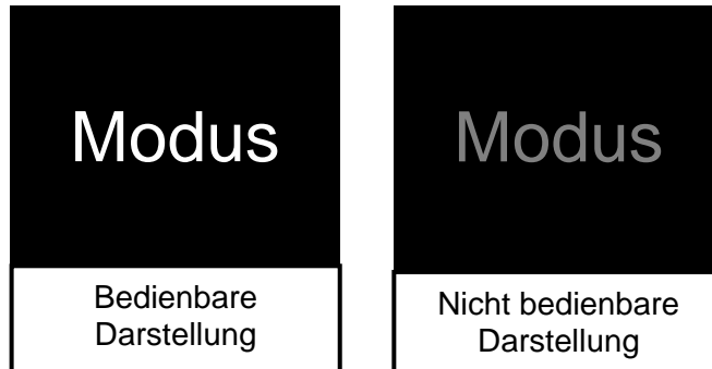
Abbildung 4-4.1: Kennzeichnung anwählbarer Touchfelder im MFD
