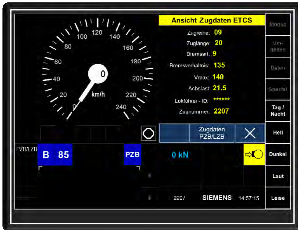
Abbildung 5-1-8.1 MFD-Bild „Ansicht Zugdaten ETCS“ (nach gestartetem SOM)
