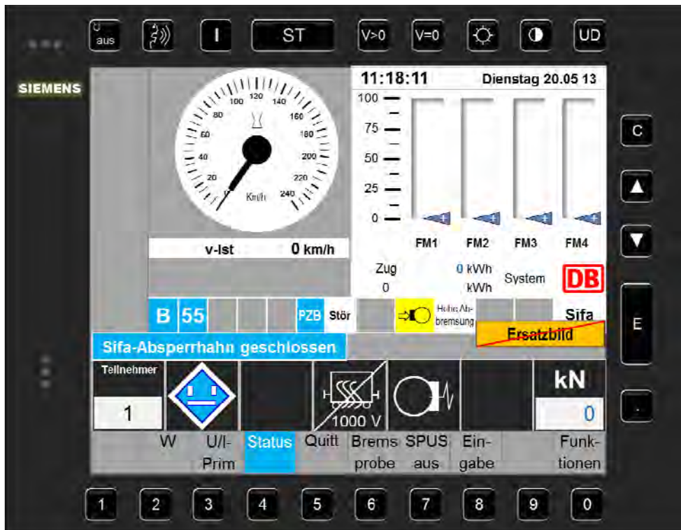
Abbildung 3-10.1: MTD-Ersatzbild mit Anzeige der v-ist dezimal unterhalb des analogen Geschwindigkeitszeigers
