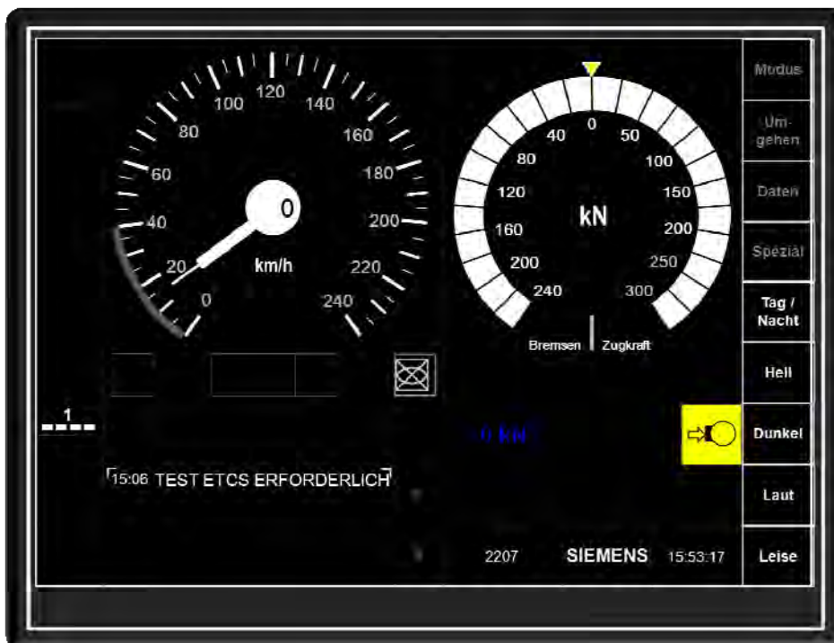
Abbildung 5-3-1.3 MFD-Grundbild mit Aufforderung zur Bestätigung der Transition zu „ETCS Level 1“
