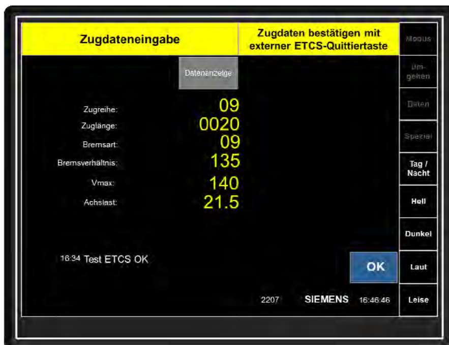
Abbildung 5-1-4.3 MFD-Bild „Zugdateneingabe ETCS“ nach dem Bestätigen mit der ETCS-Quittiertaste
