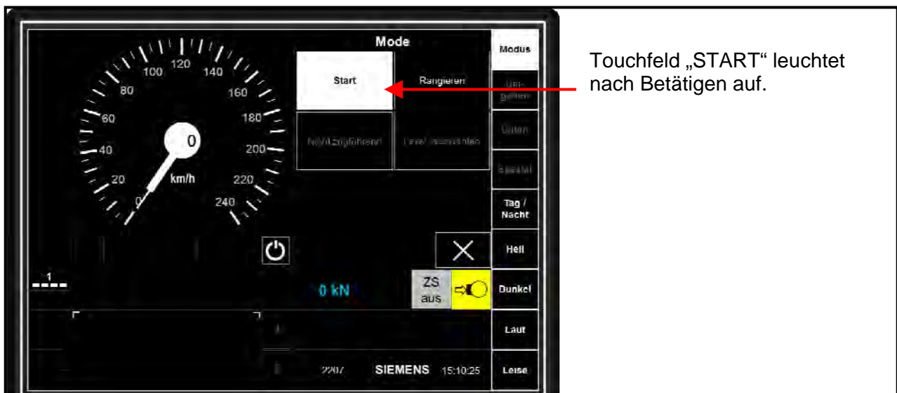
Abbildung 5-1-7.2 MFD-Bild „Mode“ zum Start des Mode
