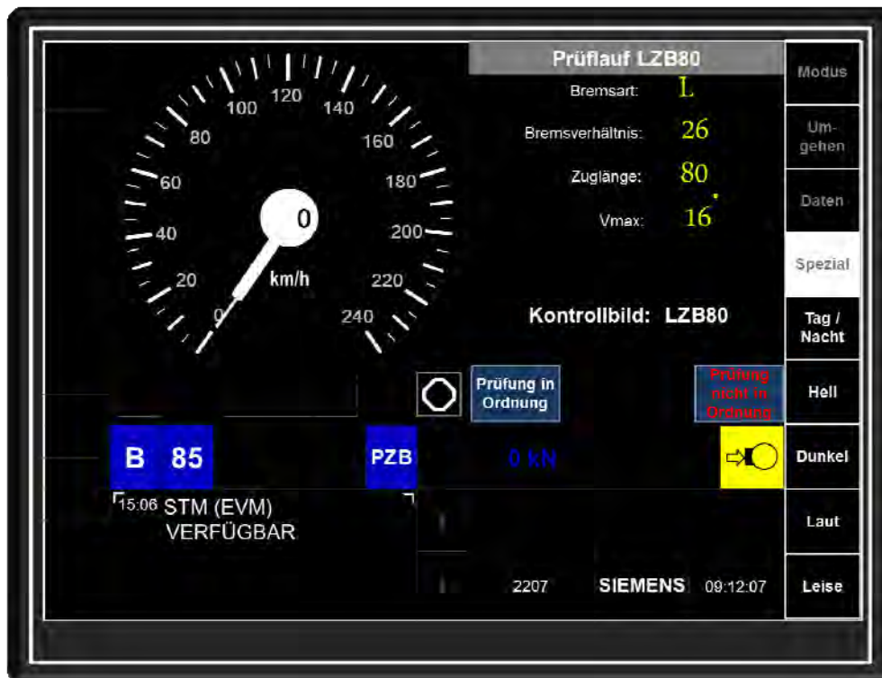
Abbildung 7-4.2 MFD-Bild bei Beginn des „Prüflauf LZB80“
