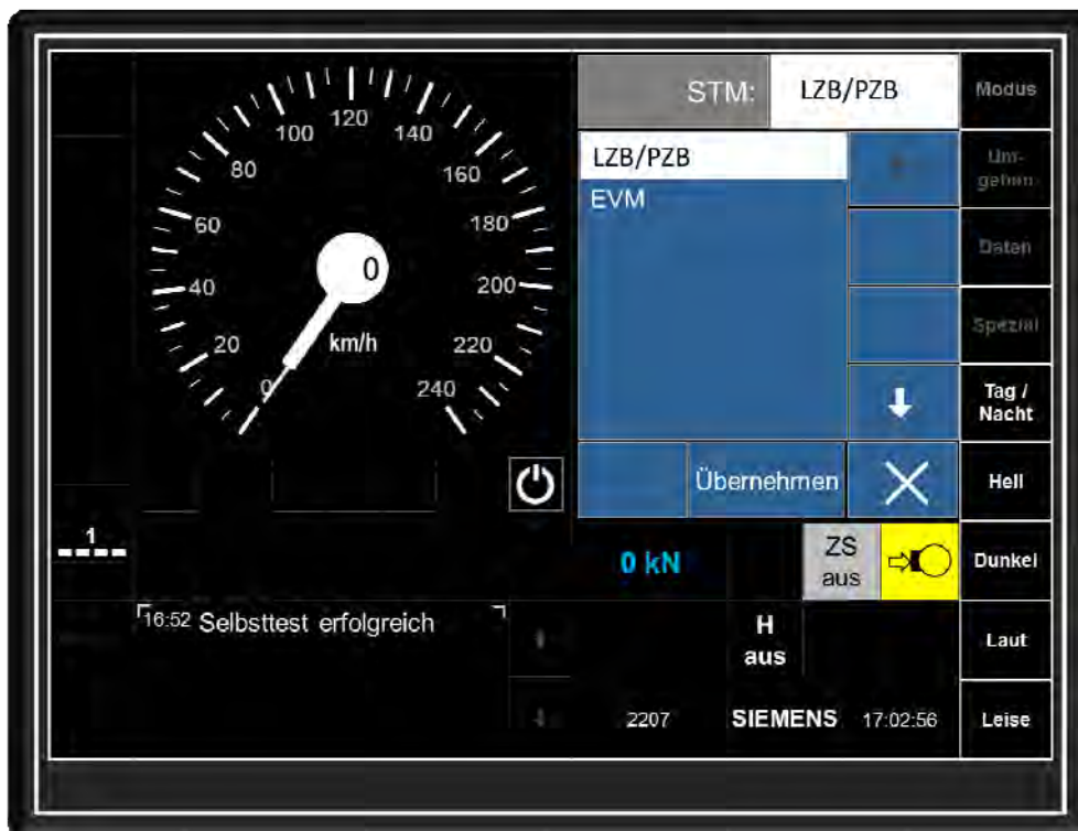
Abbildung 5-1-2.5: MFD-Bild „Eingabe ETCS Level“ mit ausgewähltem STM „PZB/LZB“ und der Möglichkeit zum Bestätigen mit Touchfeld „Übernehmen“
