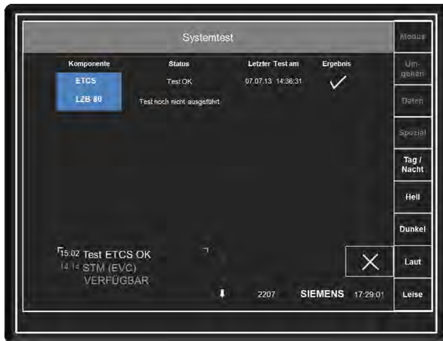
Abbildung 6-2.2 MFD-Bild „Systemtest“ nach einem ETCS-Test
