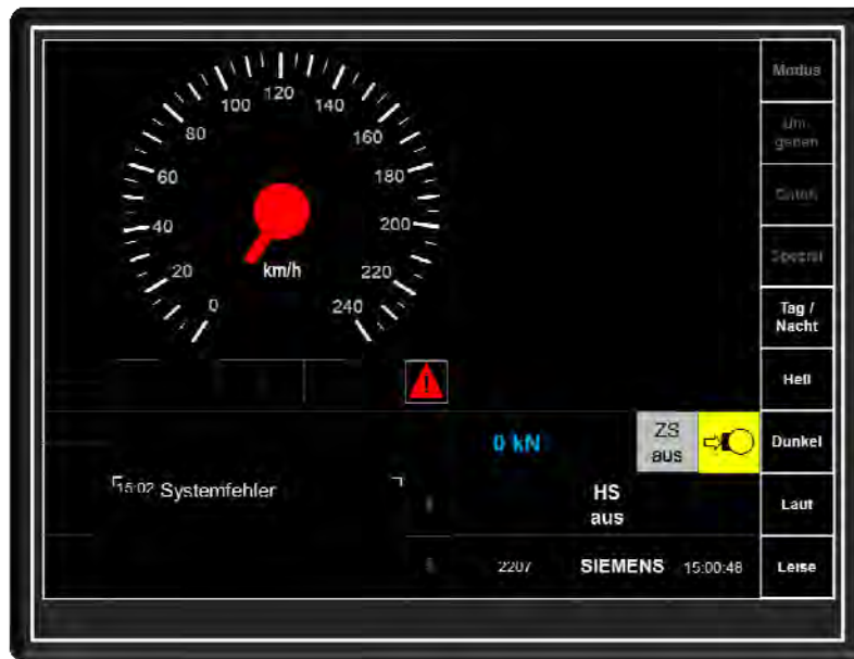
Abbildung 6-2.4 MFD-Grundbild nach Übergang des EVC in den Mode „Systemfehler“
