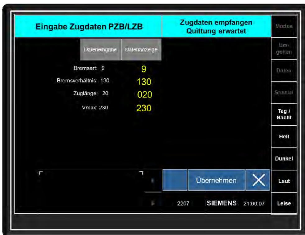
Abbildung 7-1.5 MFD-Bild „Zugdateneingabe“ (mit eingegebenen Zugdaten)
