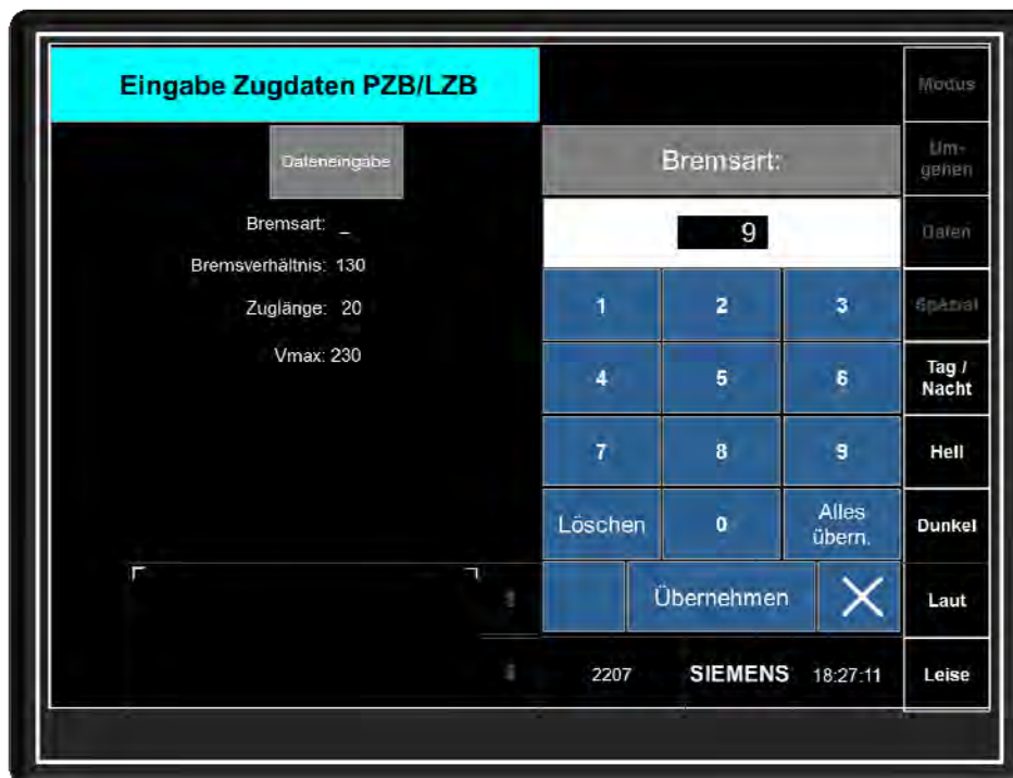
Abbildung 7-1.4 MFD-Bild „Zugdateneingabe“ (mit aktiver Eingabe der Bremsart)
