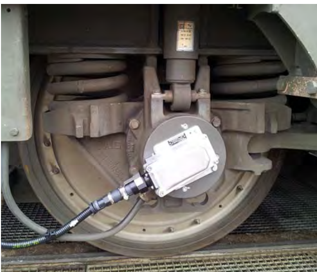
Abbildung 3-7.2: Wegimpulsgeber ETCS-Odometrie am Radsatzlagergehäuse
