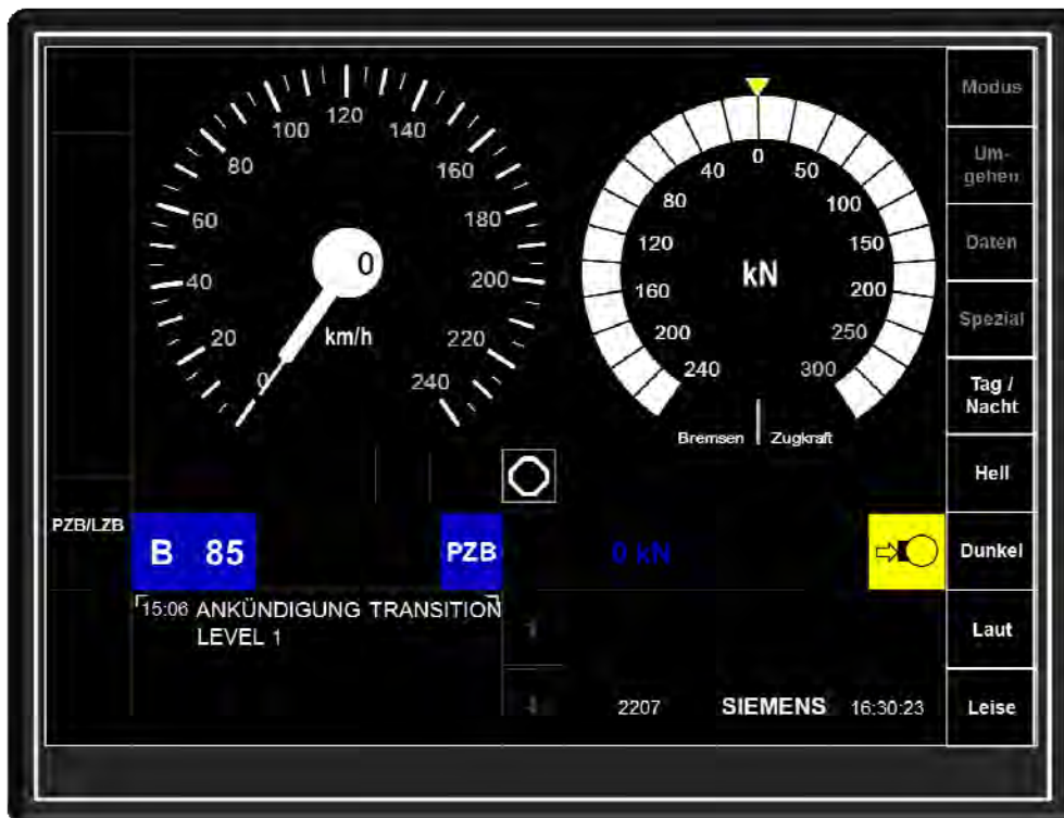
Abbildung 5-3-1.2 MFD-Grundbild mit Ankündigung einer Transition zu „ETCS Level 1“
