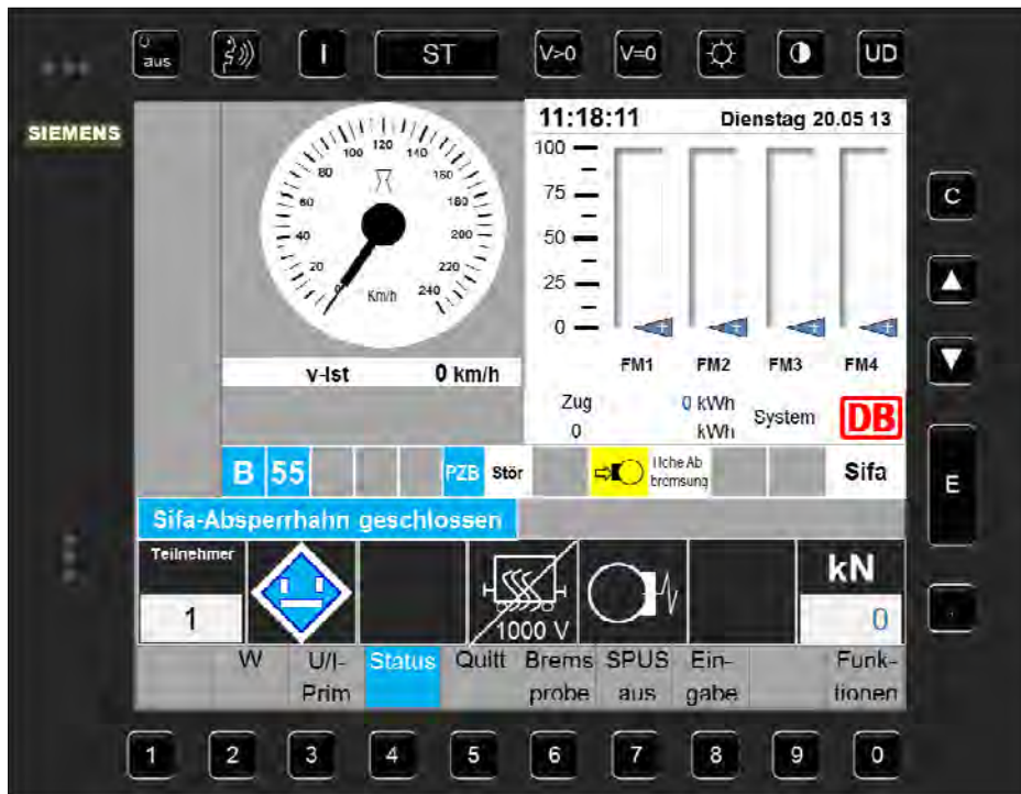
Abbildung 8-1.2: MFD-Ersatzbild im MTD nach Bestätigen mit der „E“-Taste
