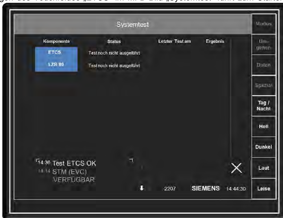
Abbildung 6-2.1 MFD-Bild „Systemtest“ wenn noch keine Tests durchgeführt wurden
