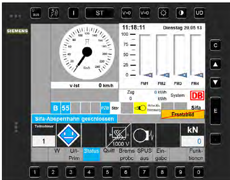
Abbildung 8-1.5: MFD-Ersatzbild im MTD mit Bestätigungsaufforderung zum Ausschalten des Ersatzbildes mit der „E“-Taste
